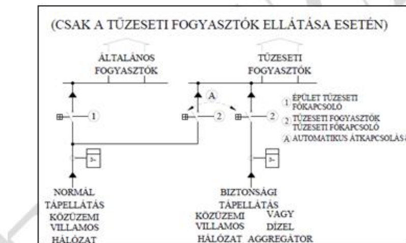
7. ábra Tüzeseti fogyasztók ellátás kettős biztonságu betáplálással „B”
