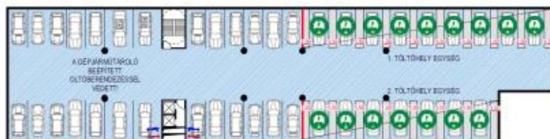
12. ábra – Példa a töltőhelyek kialakítására az a) pontban rögzített feltételek teljesülése esetén és a töltési pontonkénti teljesítmény nem haladja meg a 22 kW-ot
