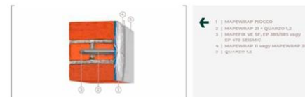
3. ábra: Falazat fugáinak kitöltése, Forrás: MAPEI Szerkezeti Megerősítés, kézikönyv, 148. o.
